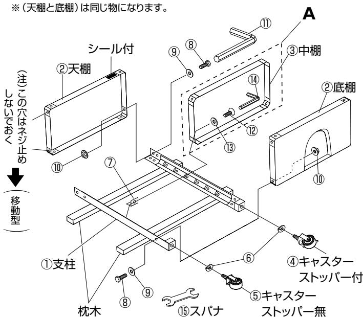
〔キャスターの取付けは、⑥バネ座金をはめ込み付属のスパナで締め付けます。
