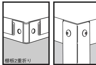
●棚板コーナー部は、サカエ独自の支柱側面突き合わせ型及び、2重折り構造のためぐらつきが無く、また、棚板の強度も強く、非常に堅牢です。
